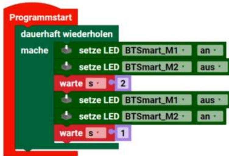
Die Fußgängerampel hat zwei LEDs, die abwechselnd leuchten. Die Zeiten für Rot- und Grünphasen sind unterschiedlich. Blöcke sind aus Ausgang und Util
