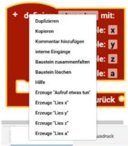
Hier hätte man vier Eingänge. Mit einem Rechtsklick auf den Block kann man die Funktion als Block in das Programm einsetzen oder die Variablen (x-a) in dem Unterprogramm verwenden.
