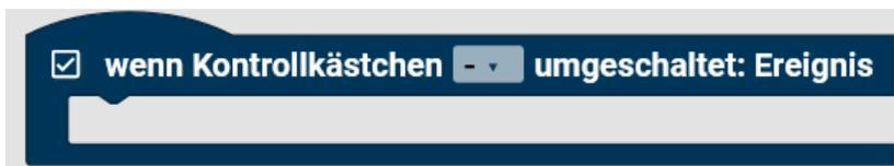
Wenn das ausgewählte Kontrollkästchen umgeschaltet wird, wird dieses Unterprogramm ausgeführt.
