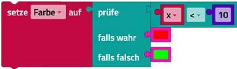
Ein dreier Block kann immer durch einen **wenn-sonst**-Block ersetzt werden. Die folgenden zwei Beispiele sind genau gleich.
