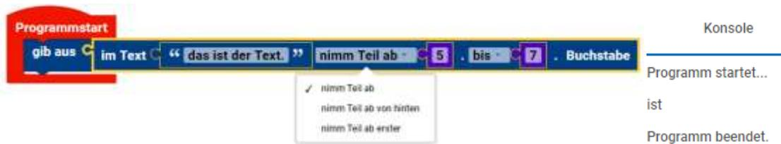
Wie mit einer Schere wird der Text von 5 bis 7 ausgeschnitten.
