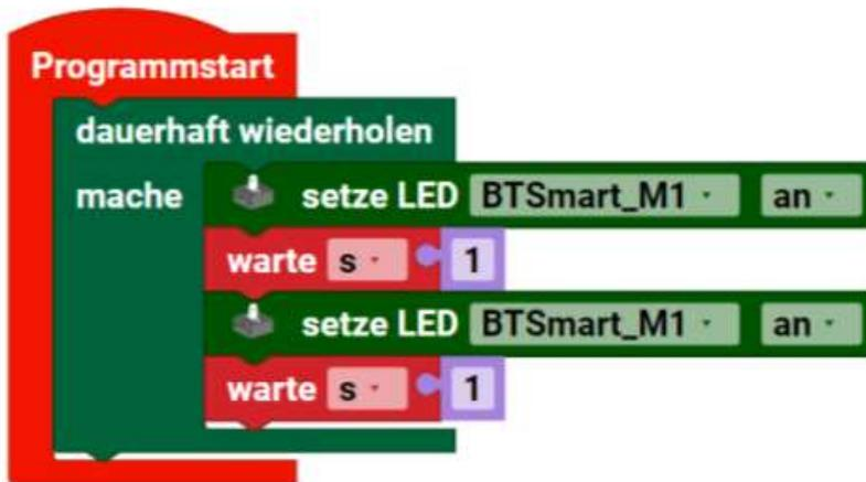
Eine Dauerschleife, wo die LED eingeschaltet wird, 1 Sekunde warten, die LED ausgeschaltet wird und wieder eine Sekunde gewartet wird. Ein neuer Durchlauf beginnt. Gestoppt wird das Programm oben links das „Quadrat“ Stopp. Neben dem „Dreieck“ Start, im blauen Feld.
