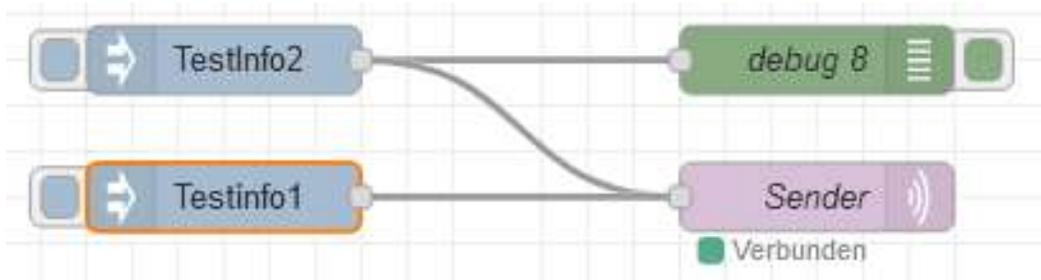
In NodeRed werden zwei Injektion mit dem Inhalt Testifo1 und Testinfo2 erstellt, die beide an den Sender die Daten senden. Zusätzlich wird beim Debug 8 die gesendeten Daten ausgegeben.
