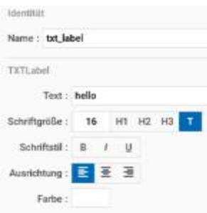
Unter Größe und Position wird der Name des Feldes eingetragen. Robo Pro Coding gibt hier den Namen „txt\_label“ schon vor. Als Text wird „hello“ vorgegeben. Das ist der Text, der beim Starten vom Programm auf dem Beschriftungsfeld angezeigt wird. Weiterhin kann man die Schriftgröße, Stil, Ausrichtung und die Farbe ändern.
