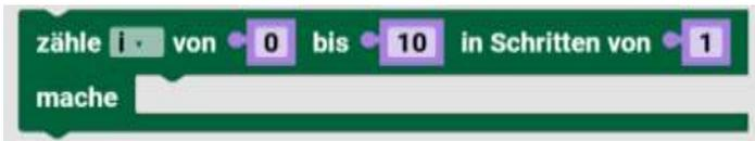
Die **zählen-von-bis**-Schleife erhöht einer Variable den Wert, beginnend mit einem ersten Wert, endend mit einem zweiten Wert und in Schritten von einem dritten Wert, wobei der Körper für jeden Wert der Variable einmal ausgeführt wird. Das folgende Programm gibt zum Beispiel die Zahlen 1, 3 und 5 aus.
