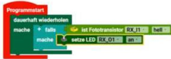
Wenn wir dieses Programm starten würden, geht die LED an, sobald der Fototransistor beleuchtet wird. Aber sie bleibt an, weil sie nie abgeschaltet wird. Jetzt könnte man einen weiteren "falls mache" Block einfügen, mit Fototransistor dunkel und LED aus. Dann würde es so aussehen.
