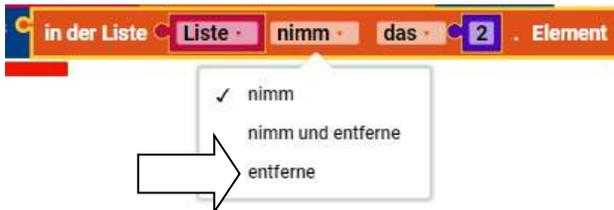
**Achtung:** Wenn du im Dropdown-Menü „entfernen“ wählst, verschwindet die Nase links vom Block:
