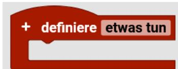
Mit dem einfachen Funktionsblock lässt sich eine Funktion erstellen, die den im Textfeld eingegebenen Namen trägt. Die Funktion kann beliebig viele Variablen enthalten, die über das Plusymbol hinzugefügt werden können. Diese Funktion „**Altern**“ addiert 1 zu der Variable **Alter**:
