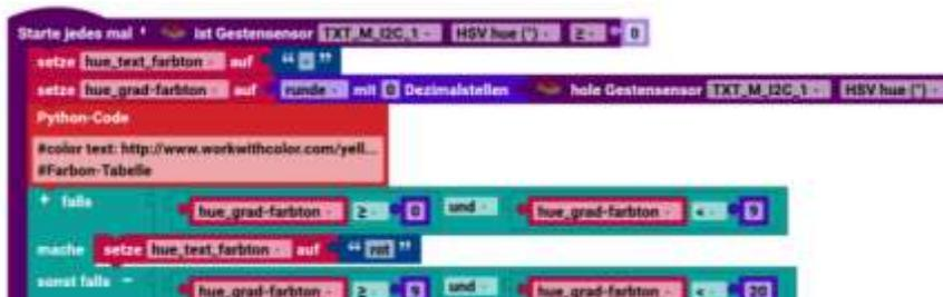
Das Unterprogramm startet nur wenn der Farbton größer gleich 0 ist. Als erstes wird die Variable hue\_text\_farbton auf „-“ gesetzt. Dann wird vom Sensor der Farbtonwert geholt und in die Variable „hue\_grad-Farbton“ geschrieben. Der Python-Code ist nur ein Hinweis auf eine Hue-Farbtabelle.
