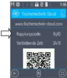
Man bekommt einen Kopplungscode, den man bei der Anmeldung bei der fischertechnik Cloud eingeben muss. Dieser Kopplungscode hat eine Gültigkeit von 30 Minuten. Danach muss man einen neuen Kopplungsvorgang starten.
