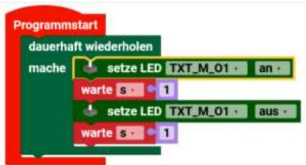
Das Programm macht in einer Dauerschleife, die LED am O1 des TXT 4.0 (Master) an, wartet 1 Sekunde, schaltet sie aus, wartet 1 Sekunde und wiederholt die Schleife. Es ist ein Blinklicht.
