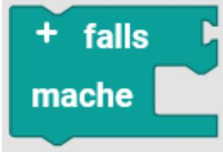
Der „falls mache“ Block prüft, ob eine Bedingung wahr oder falsch ist. Wenn sie wahr ist werden die weiteren Blöcke innerhalb ausgeführt. Wenn die Bedingung falsch ist, wird zum nächsten Block weitergegangen. Durch das Klicken auf das + wird eine weitere Prüfung „sonst falls“ mit einer anderen Bedingung eingefügt.
