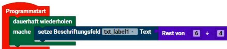
In einem Beschriftungsfeld wird der Rest der Division 6/4 angezeigt.
