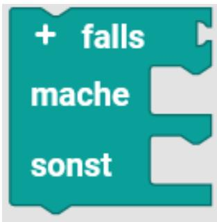
Der „falls mache“ Block prüft, ob eine Bedingung wahr oder falsch ist. Wenn sie wahr ist werden die weiteren Blöcke innerhalb ausgeführt. Wenn die Bedingung falsch ist, werden die weiteren Blöcke im unteren Teil bei „sonst“ ausgeführt.
