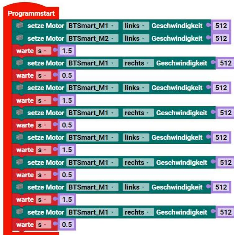
Das Programm läuft einmal durch und endet dann. Als erstes werden beide Motoren eingeschaltet und 1,5 Sekunden laufen gelassen. Dann wird die Drehrichtung vom M1 umgekehrt und für 0,5 Sekunden laufen gelassen. Es gibt eine Abfolge der Drehrichtungsumkehr von M1 mit verschiedenen Zeiten. Danach endet das Programm.
