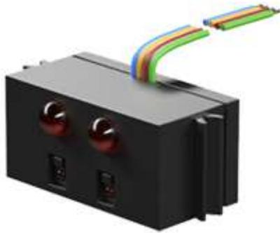
Der Infrarot-Spursensor ist ein digitaler Sensor zur Erkennung einer schwarzen Spur auf weißem Untergrund, der bei einem Abstand von 5-30 mm von Sensor zu Untergrund arbeitet. Der richtige Abstand ist sehr wichtig! Auch Fremdlicht sollte so wenig wie möglich um den Sensor herum sein.
