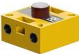
Der Widerstand des Fotowiderstands sinkt, wenn er mehr Helligkeit ausgesetzt ist. Der ausgegebene Wert des Fotowiderstands ist also ein Maß für Helligkeit.
