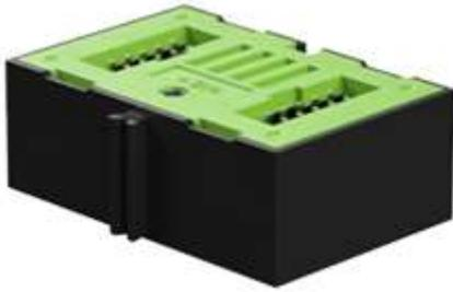
Der Umweltsensor vereint die vier Funktionen Luftqualitätssensor, Luftfeuchtigkeitssensor, Barometer und Thermometer in einem Bauteil. Intern ist ein BME680 Sensor verbaut.
