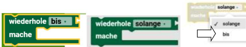
**wiederhole solange**-Schleifen wiederholen ihren Körper, **solange** eine Bedingung erfüllt ist. **wiederhole bis**-Schleifen sind ähnlich, mit dem Unterschied, dass sie ihren Körper so lange wiederholen, **bis** eine bestimmte Bedingung erfüllt ist. Die folgenden Blöcke sind Äquivalent zum vorherigen Beispiel, weil die Schleife läuft, bis **insgesamt** größer oder gleich 30 ist.
