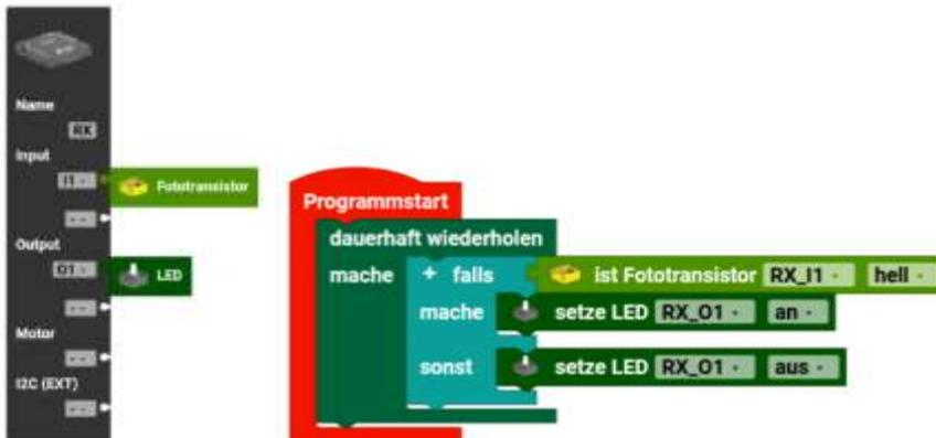
Die Bezeichnung vom Fototransistor ist RX\_I1 und die LED an RX\_O1. Somit ist der Fototransistor am RX-Controller und dort am I1 und die LED am Ausgang O1. Momentan kann nur ein RX Controller angeschlossen werden.
