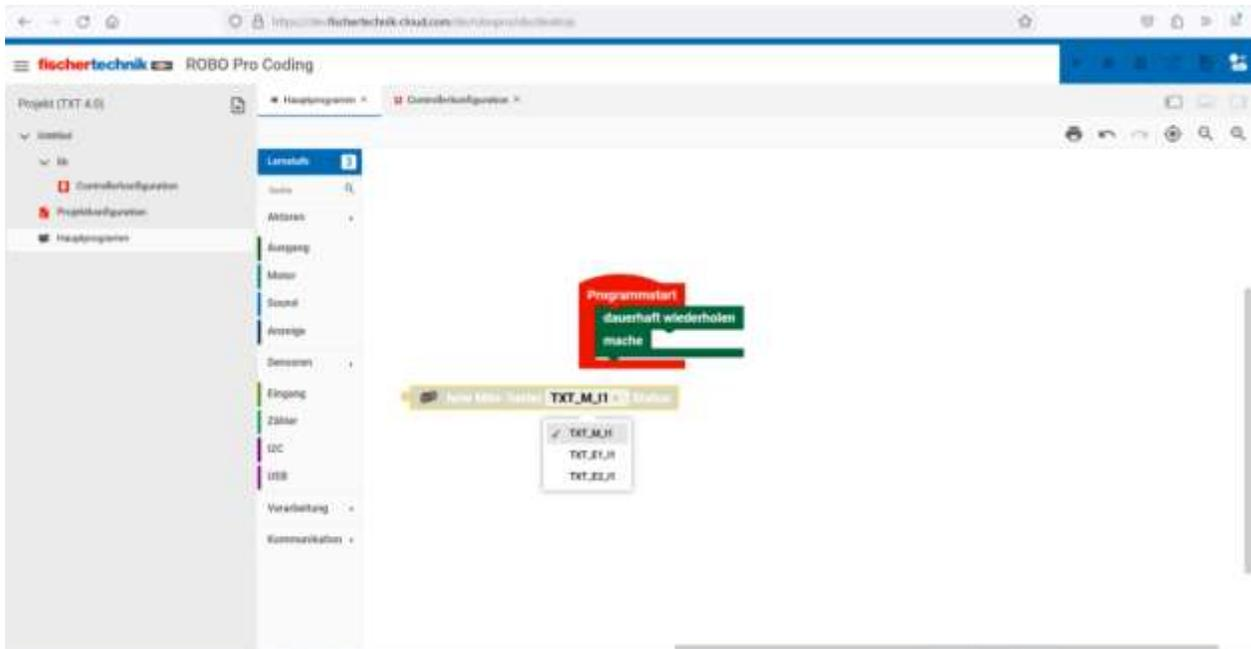
Die Auswahl der Taster erweitert sich um die entsprechenden Taster der Extensions. Hier kann man sich zwischen dem Taster am Master oder der Extensions 1 oder 2 entscheiden.
