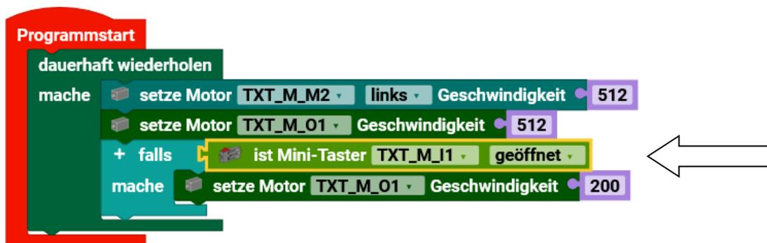
Von Robo Pro Coding ist automatisch "I1" ausgewählt worden. Wenn wir das Programm laufen lassen würden. Werden beide Motoren laufen, wobei man mit dem Drücken und Loslassen des Tasters, die Geschwindigkeit des Motors an O1 ändern kann.
