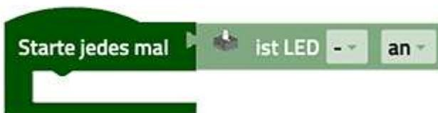
Hier wird ein Programm ausgeführt, wenn die LED an ist. Hier fehlen aber noch das Programm und der Ausgang, wo die LED angeschlossen ist. Wenn man vorher keinen Ausgang mit einer LED in der Controllerkonfiguration angeschlossen hat, kann man den Block nicht in das eigene Programm einfügen. Der Rechte Teil ist heller, da es ein Vorschlag von Robo Pro Coding ist. Wenn man nichts ändert, wird er im Programm ausgeführt.
