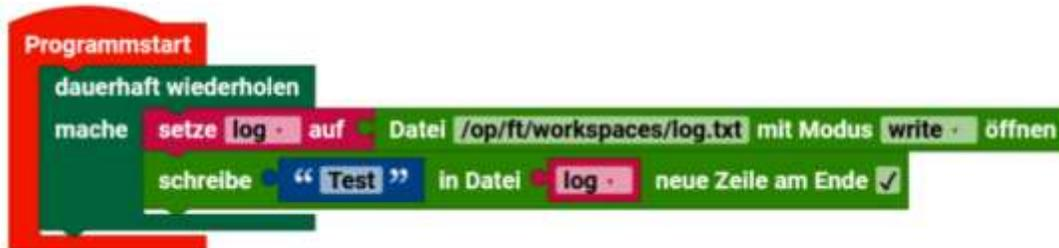
In diesem Beispiel wird das Wort „Test“ in eine Datei geschrieben. Nur einmal, auch wenn man das Programm mehrfach aufruft, steht in der Datei log.txt nur einmal das Wort Test.
