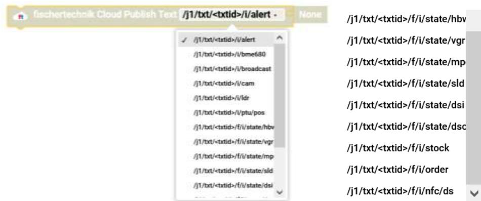
Man kann hier die Unterverzeichnisse auswählen. U.a. die fischertechnik Industrieanlage SLD (Sortieranlage) oder den Stock/Order Ordner, von wo aus die Daten an das Dashboard gesendet werden können.
