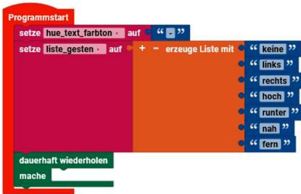
Nach dem Starten wird in die Variable „hue\_text\_farbton“ ein Minus für Leer gegeben. Dann wird eine Liste erzeugt mit 7 Begriffen erzeugt. Sie sind für die erkannte Bewegungsrichtung (Geste). Dann wird eine leere Endlosschleife durchlaufen. Dadurch läuft das Programm weiter, bis man Stopp auf dem Controller oder in Robo Pro Coding drückt. Es werden also nur die Variablen gesetzt.
