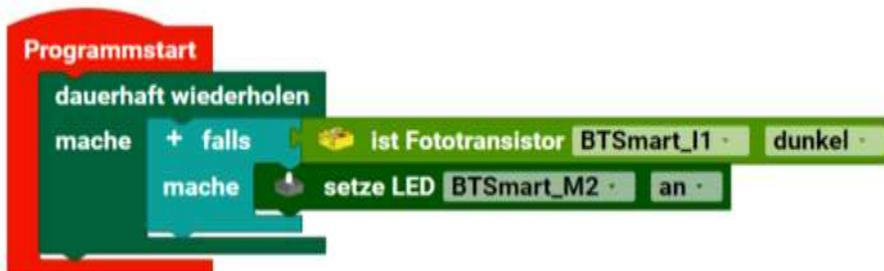
Hier muss man beim Fototransistor "dunkel" einstellen, da er ja von der Lampe die ganze Zeit beleuchtet wird und erst wenn man den Lichtstrahl unterbricht, das Signal ist, auf das man wartet.
