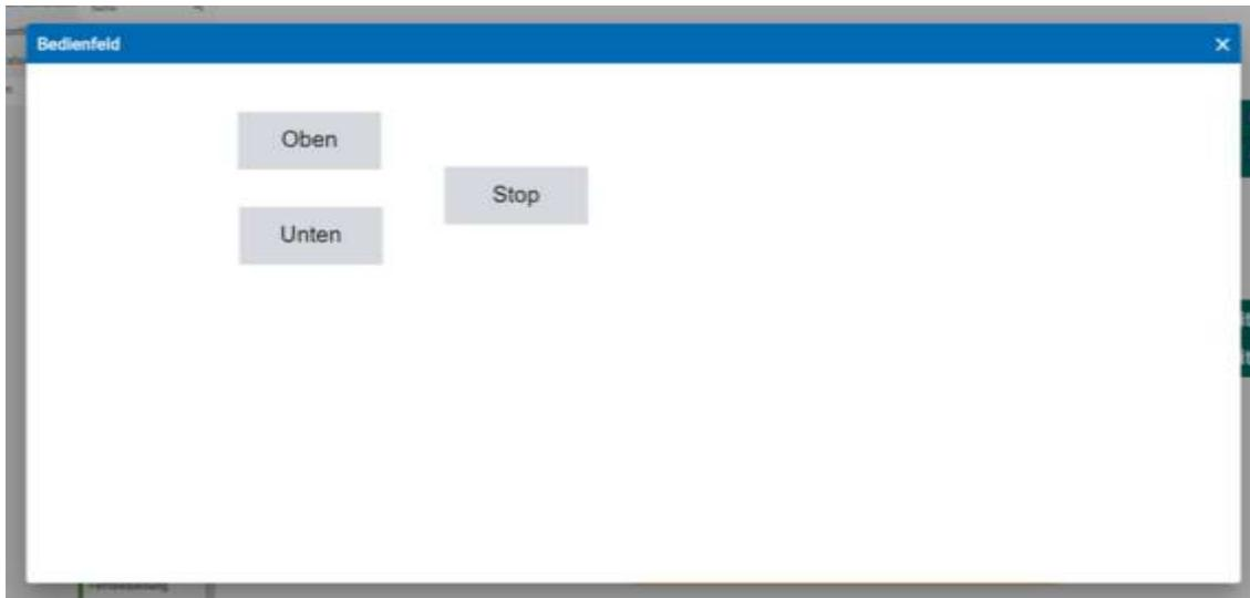
Durch das Drücken mit der Maus auf den jeweiligen Button, wird das jeweilige Unterprogramm ausgeführt. Es werden also die Motoren M1 und M2 mit entsprechender Richtung eingeschaltet oder beide ausgeschaltet.
