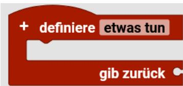
„definiere etwas tun“ – Block. Dieser Block erlaubt es eine Funktion mit Rückgabewert zu erstellen. Dieser Rückgabewert kann dann im Hauptprogramm weiterverwendet werden. Hier ein Beispiel:
