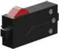
Der Taster ist ein digitaler Sensor, der "Es fließt Strom" von "Es fließt kein Strom" unterscheidet. Ob Strom fließt, hängt dabei sowohl von der Verkabelung, als auch davon ab, ob der Taster gedrückt ist. Man kann den Taster also auf zwei verschiedene Arten verwenden:
