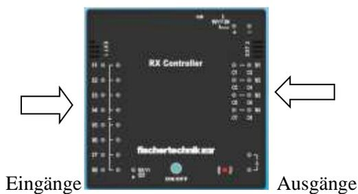
Beim Schnittstellentest vom RX Controller, kann man wie beim TXT 4.0 die Eingänge abfragen und einstellen. Auch die Motoren und die O-Ausgänge lassen sich einstellen. Nicht vorhanden sind die Servoausgänge und die schnellen Zähler. In der Anzeige unten ist noch der I2C Anschluss zu sehen. Dort kann man den Sensor auswählen und die entsprechenden werden Werte angezeigt.
