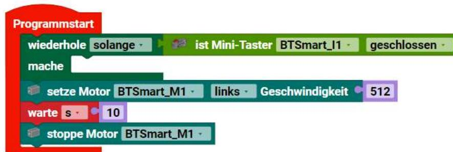
Blöcke kommen aus: Schleifen, Eingang, Motor und Util. Das Programm läuft einmal durch. Es startet und dann wartet es, bis der Taster geschlossen ist. Dann wird der Motor M1 auf volle Geschwindigkeit gesetzt, er läuft 10 Sekunden und wird dann wieder abgeschaltet.
