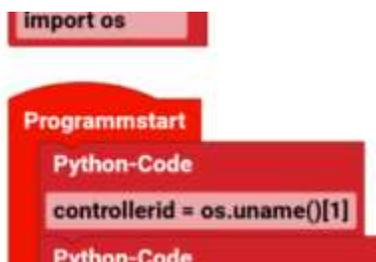
Hier wird der Variablen „controllerid“ der Wert vom Betriebssystem übertragen.
