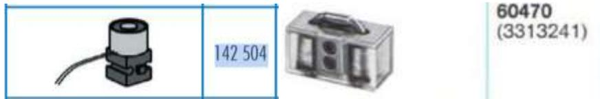
Anschluss von den Polen ist egal. Zum Lösen sollte man kurz die Spannung umkehren. So bleiben die Eisenteile nicht kleben. Man kann auch Tesafilm auf den Magneten kleben. Dann kann man ausprobieren ob nicht auch ein O-Ausgang reicht statt eines M-Ausganges. Es gab auch eine Bauform mit einer Spule.
