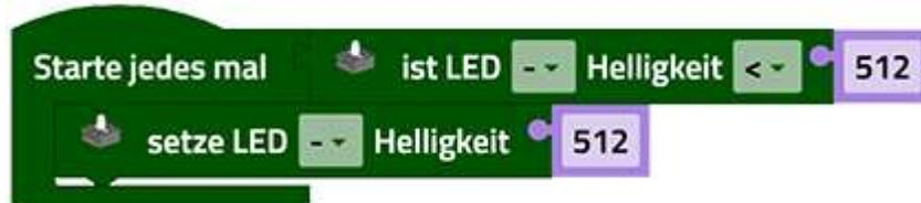
Mit den Blöcken **ist LED ...** und **ist LED Helligkeit ...** kann man die Aktivität beziehungsweise die Helligkeit einer LED als Bedingung nutzen. Im Beispiel wird die Helligkeit der LED auf 512 gesetzt, sofern sie nicht schon diese Helligkeit hat.
