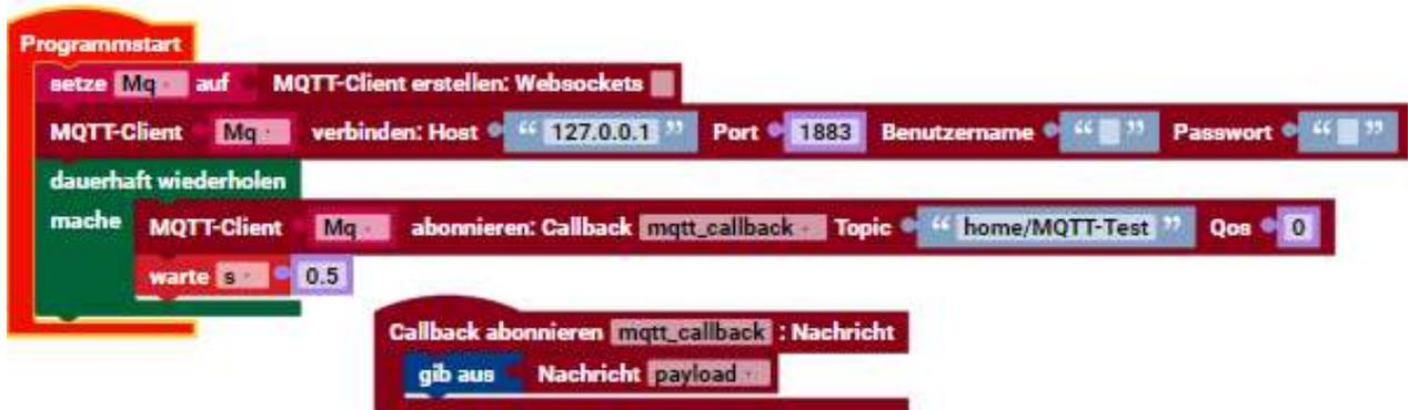
Hier wird der MQTT Broker auf dem TXT 4.0, mit 127.0.0.1 (Lokal) ohne Passwort und Benutzername geöffnet.
