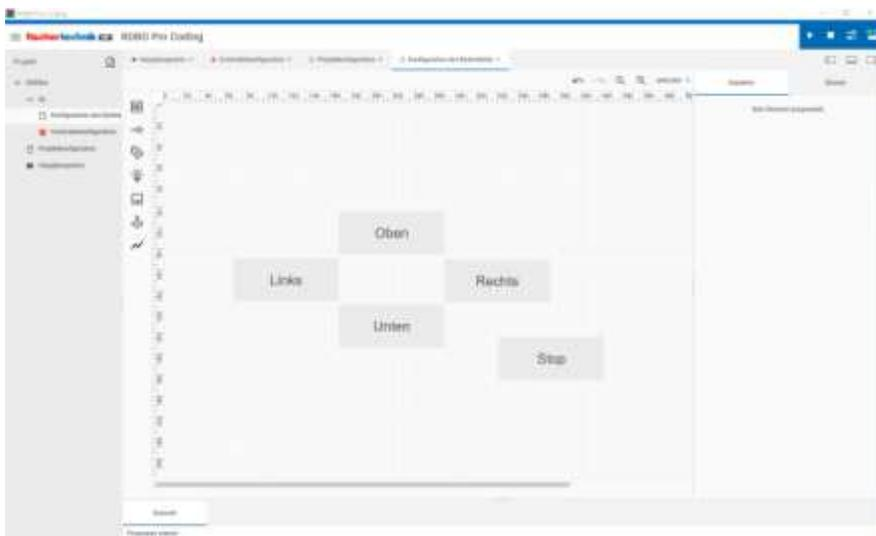
Hier kommen zum Programm Fernsteuerung 1 noch zwei weitere Buttons dazu. Dazu verschieben wir die Buttons. Wenn man hintereinander die Buttons neu rüber zieht, werden die Namen einfach mit fortlaufenden Zahlen markiert remote\_button1, remote\_button2... damit das Programm sie unterscheiden kann. Diesen Namen und Texte einfach überschreiben. Es sollte nun so aussehen.
