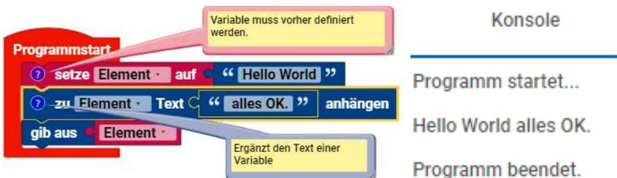
Nach dem Starten wird die Variable „Element“ mit dem Inhalt „Hello World“ gefüllt. Zu dem Inhalt, wird „alles OK.“ angehängt. Anschließend wird der neue Inhalt auf der Konsole ausgegeben.
