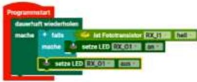
Wir ziehen den LED Baustein unter das "falls mache". Wenn wir das Programm laufen lassen, stellen wir fest, dass die LED nur minimal angesteuert wird, wenn der Taster gedrückt wird. Sie wird zwar eingeschaltet aber sofort danach wieder Ausgeschaltet. Der "falls mache" Block ist also nicht ganz der richtige.
