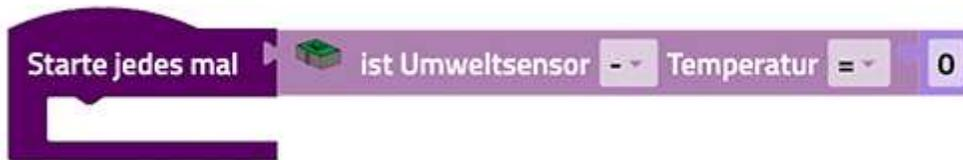
Der **Starte jedes mal-Block** bietet die Möglichkeit ein Programm ablaufen zu lassen, wenn eine Bedingung erfüllt ist. Er funktioniert also ähnlich wie eine Fallunterscheidung wird aber nicht nur einmal durchlaufen, sondern jedes Mal, wenn die Bedingung erfüllt ist, während des gesamten Ablaufs des Programms.
