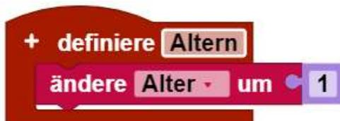
Hinweis: Obwohl diese Funktion keinen Rückgabewert hat, ändert sie eine Variable. Und Variablen sind in Robo Pro Coding „Global“. Sie können von allen Unterprogrammen gelesen und geändert werden. Es gibt keine neuen globalen Variablen mit genau demselben Namen. Wenn man Funktionen aus anderen Programmen nutzen möchte, sollte man auf die Namen achten. Negatives Beispiel ist „Zähler“. Wenn er in mehreren Funktionen verwendet wird, kann es zu Verwirrungen führen.
