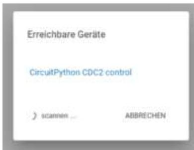
Der fischertechnik RX-Controller meldet sich momentan als „CircuitPython CDC2 control“ an der USB Schnittstelle vom PC an. Es wird aber weiter gescannt.
