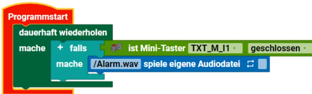
Wenn der Taster gedrückt ist, wird der Sound „Alarm.wav“ einmalig, also nicht in Dauerschleife, abgespielt.
