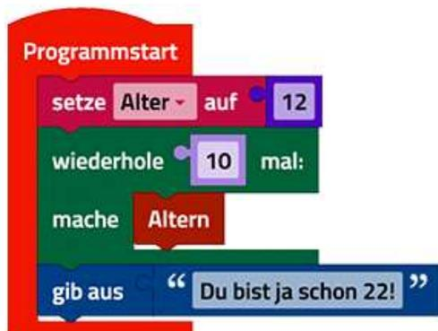
Das Programm setzt die Variable „Alter“ auf 12. In der Funktion „Altern“ wird 10 mal 1 dazu addiert und dann auf der Konsole ausgegeben.
