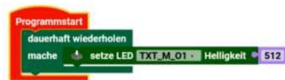
Hier wird eine LED am Ausgang O1 am TXT 4.0 (Master) mit voller Helligkeit eingeschaltet.
