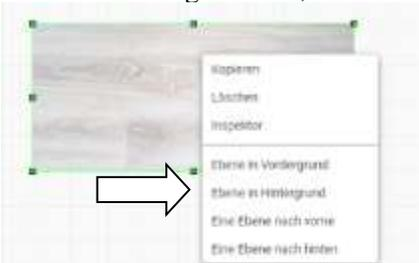
Hiermit lässt sich ein Bild auf die Bedienoberfläche legen. Entweder als Detailbild zur besseren Erkennung oder sogar als Hintergrundbild des ganzen Bedienfeldes. Über das Kontextmenü kann dann die Ebene Hintergrund ausgewählt werden.
