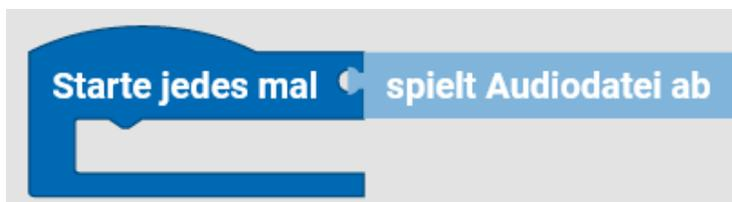
Der **Starte jedes mal-Block** bietet die Möglichkeit ein Programm ablaufen zulassen, wenn eine Bedingung erfüllt ist. Er funktioniert also ähnlich wie eine Fallunterscheidung wird aber nicht nur einmal durchlaufen, sondern jedes Mal, wenn die Bedingung erfüllt ist, während des gesamten Ablaufs des Programms. Der **Starte jedes mal-Block** ist eine Abkürzung für folgendes Konstrukt:
