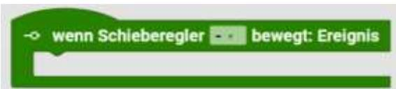
Unterprogramm wird ausgeführt, wenn Schieberegler ... bewegt wird.
