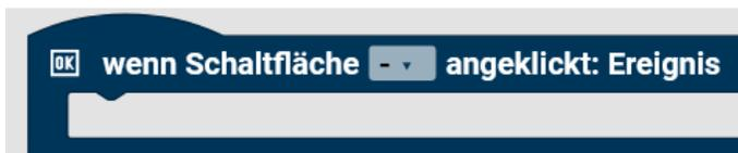
Wenn die ausgewählte Schaltfläche angeklickt wird, wird dieses Unterprogramm ausgeführt.
