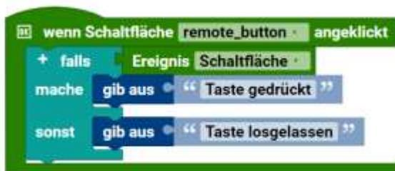
Durch den Ereignis-Block wird das wirkliche drücken des Tasters abgefragt. Bei diesem Beispiel wird jeweils der Zustand auf der Konsole ausgegeben. Man kann das Programm auch um eine Variable erweitern, um so den Zustand zu speichern und eine Art Schalter daraus zu machen.
