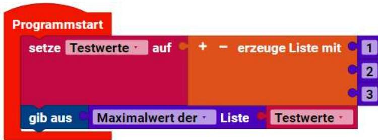
Hier wird der Maximalwert einer Liste auf der Konsole ausgegeben.
