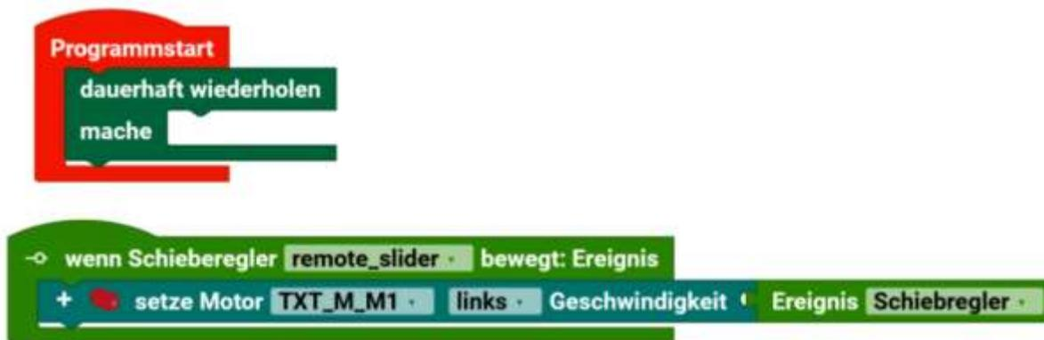
Das Unterprogramm reagiert auf eine Änderung vom Schieberegler und gibt den Wert als Geschwindigkeit an den Encodermotor.
