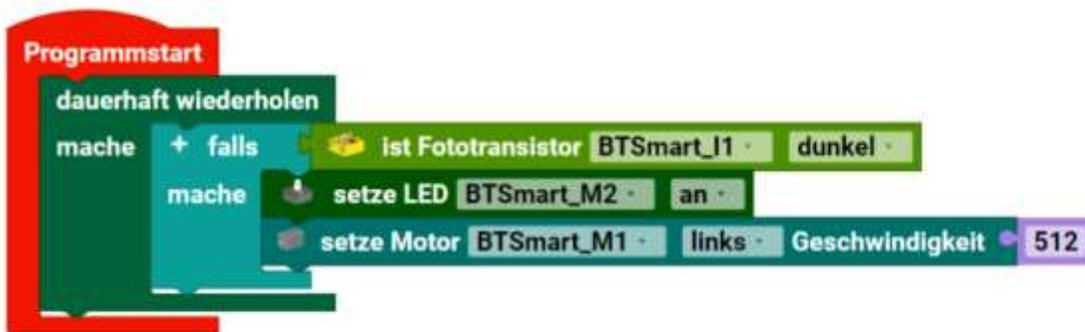
Hier wird zusätzlich der Motor über "falls" eingeschaltet. Auch dieser bleibt bis zum Programmende eingeschaltet. Es ist ja auch kein Stopp für den Motor im Programm.
