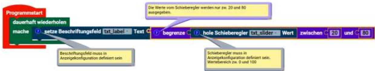
Der Schieberegler liefert Werte von 0 bis 100, es werden aber die Werte zwischen 20 und 80 genutzt. Die Werte werden auf einem Beschriftungsfeld ausgegeben.
