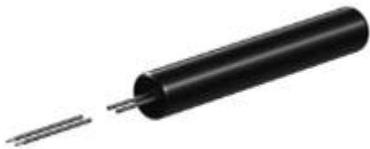
Der Reedkontakt ist ein digitaler Sensor, der "Es fließt Strom" von "Es fließt kein Strom" unterscheidet. Von der Funktion her ist er wie ein Taster. Der Reedkontakt reagiert auf Magnete. Ist ein Magnet nahe dem Reedkontakt schaltet er. Er schließt seinen Kontakt.
