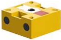
Der Fototransistor ist ein digitaler Sensor, der hell von dunkel unterscheidet.
