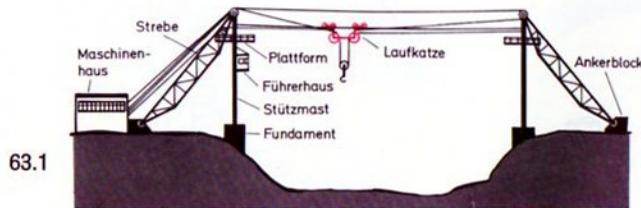
Auf die verschiedenen Kranbauarten wird in einem besonderen hobby Experimentier- und Modellbuch näher eingegangen. Hier interessiert uns vor allen Dingen die Stütze als turm- oder mastartiges Bauwerk.
