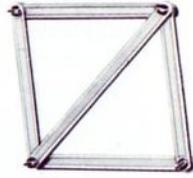
Dagegen ist es nur unter starken Zwängungen möglich, einen schlecht passenden Stab in ein statisch bestimmtes Fachwerk einzufügen (Bild 25.2). Die Stäbe werden sämtliche durch den fehlerhaften Stabeinbau bereits belastet, ehe überhaupt eine äußere Belastung aufgebracht wurde. Das gleiche gilt wieder für Temperaturdehnungen einzelner Stäbe oder Stabgruppen.
