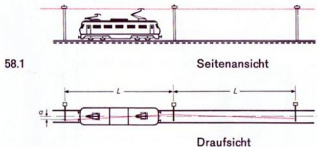
**Fahrdraht** Der Fahrdraht hat einen etwa 8-förmigen Querschnitt und wird durch Klammern so gehalten, daß das Schleifstück des
