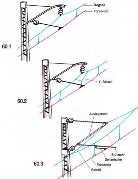
Der Seitenhalter kann bei allen diesen Konstruktionen elastisch nach oben ausweichen, wenn der Stromabnehmer unter der Fahrdrahtklemme vorbeischieft. Die Entwicklung der Fahrleitungen für höhere Geschwindigkeiten zielt also auf gleichmäßige Höhenlage des Fahrdrahtes und richtige Stützpunktselastizität ab. Ferner gibt es besondere windfeste Systeme, da die Mastentfernung nicht nur von der Schleifstückbreite des Stromabnehmers, sondern auch vom
