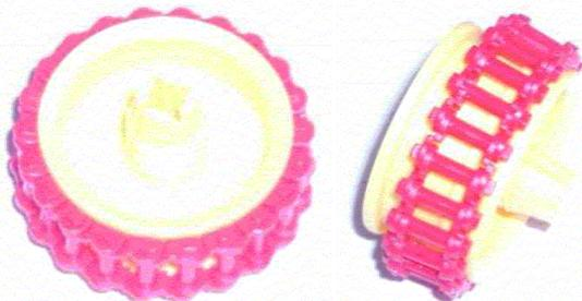
Zusammen mit dem Klebeband liegen die Kettenglieder im maximalen Toleranzbereich stramm auf. Es ist etwas schwergängig zu generieren, wirkt sich jedoch noch nicht negativ auf das Material aus.
