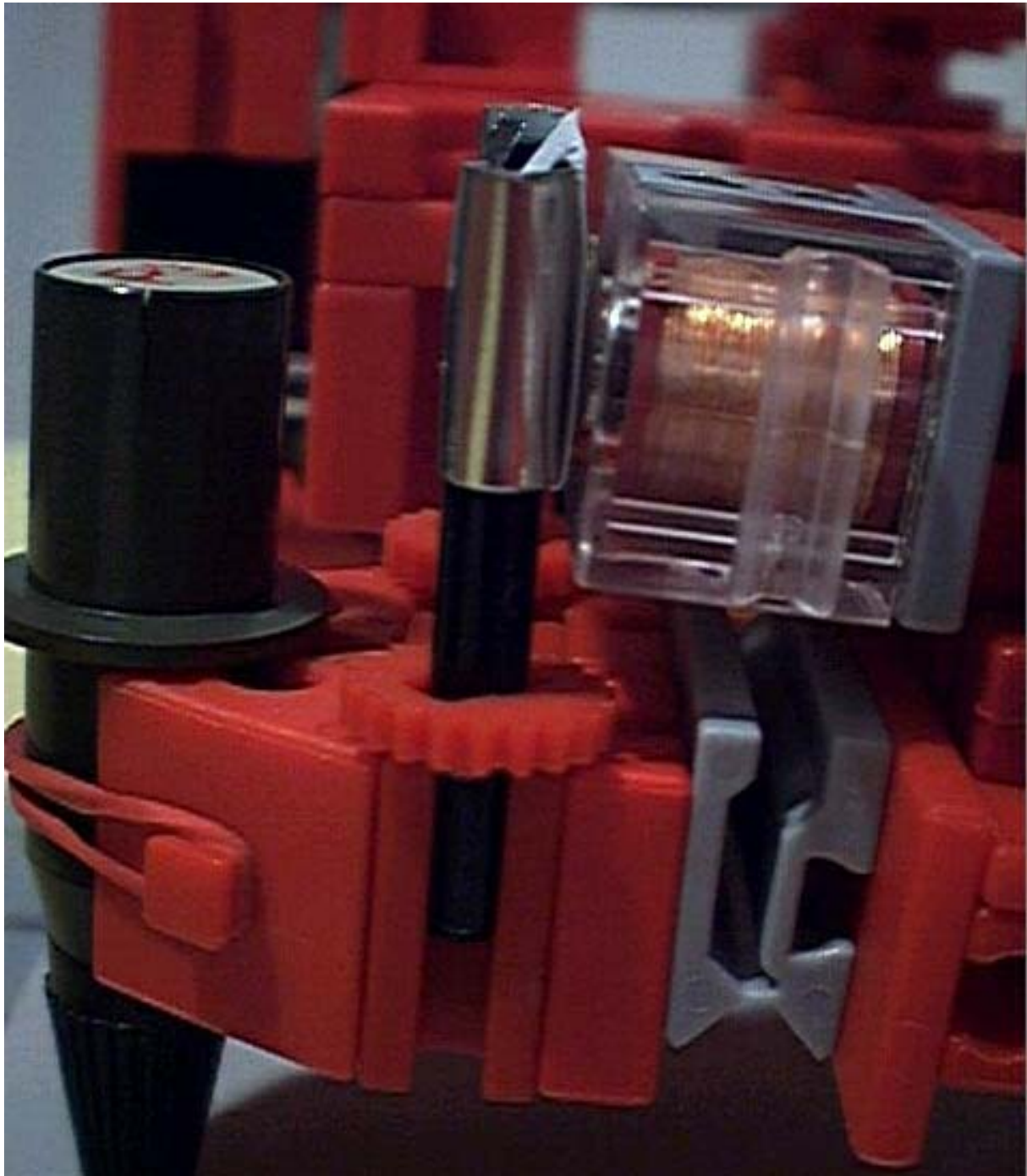
Bild 9: Plotterkopf in Seitenansicht zeigt das Blech, um den Kopf magnetisch zu heben.
