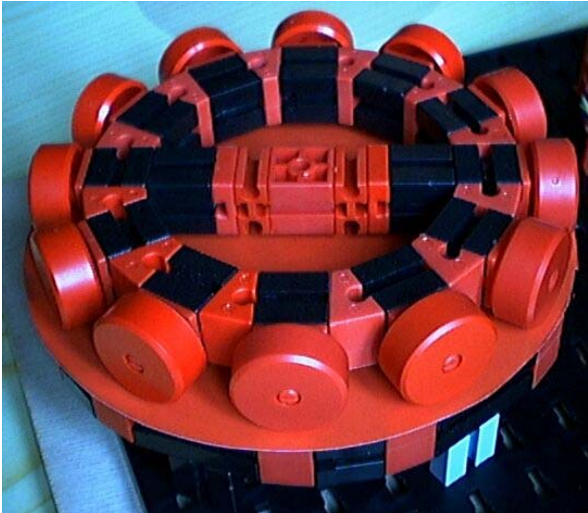
Abbildung 7: Rollenkranz mit ebener Kunststoffunterlage
