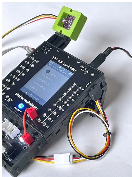
Abb. 5: Bosch BME680-Sensorplatine, angeschlossen an den EXT2-Anschluss des TXT 4.0-Controllers
