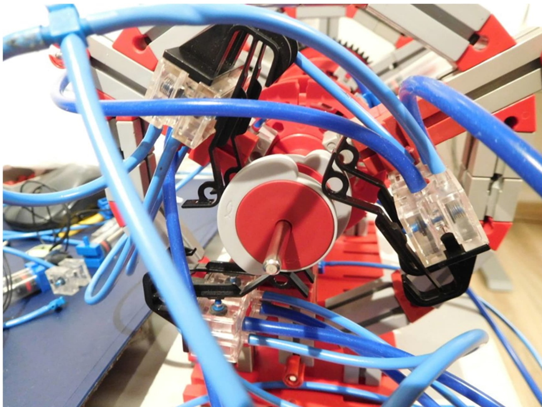
Abb. 5: Pneumatische Ventilsteuerung für Dreizylinder-Sternmotor; vordere Ventilreihe für „Push“, hintere Ventilreihe für „Pull“
