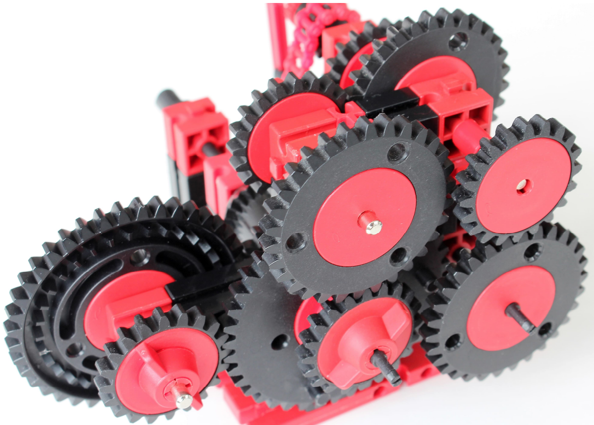
Abb. 11: Mondphasengetriebe von hinten (Mitte/rechts: drei Übersetzungen 2:3)
