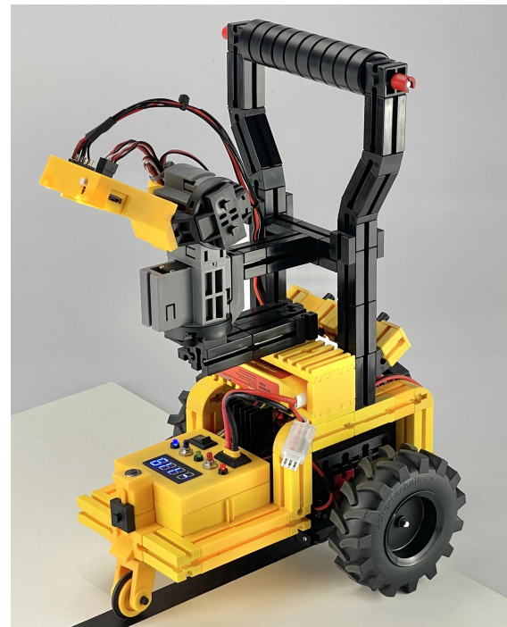
Abb. 12: Robocar mit ESP32 und Pixy2
