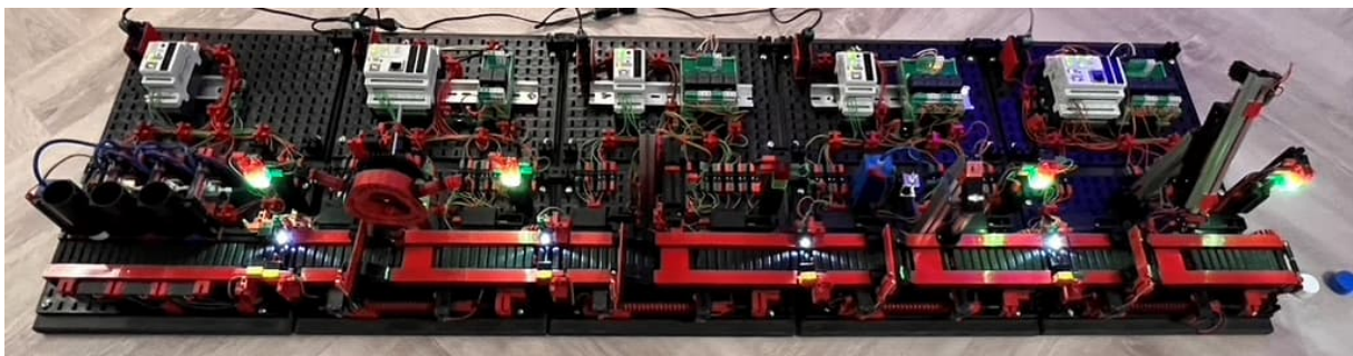
Abb. 2: Taktstraße mit fünf modularen Einheiten (Speicher, Schweißen, Bohrer, Presse, Fräsen), die jeweils von einer Controllino-SPS angetrieben werden, die die FTmodule-Bibliothek verwendet.
