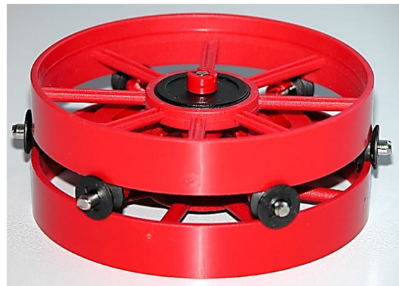
Abb. 12: Ein leichtgängiger Drehkranz
