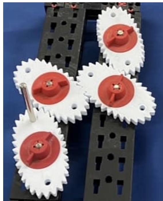
Abb. 2: Esthers ungleichförmig übersetzende Zahnräder [4]
