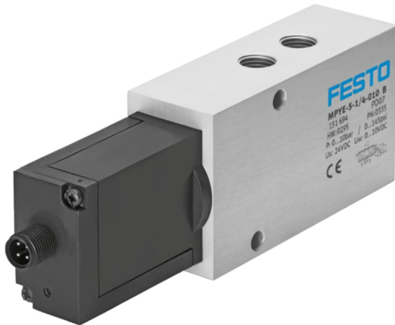
Abb. 3: Proportional-Wegeventil MPYE (© Festo SE & Co. KG) der Fa. Festo für die Verwendung mit einem externem Lageregler und Wegmesssystem zum Aufbau eines genauen pneumatischen Positioniersystems (mit freundlicher Genehmigung der Fa. Festo) [2]
