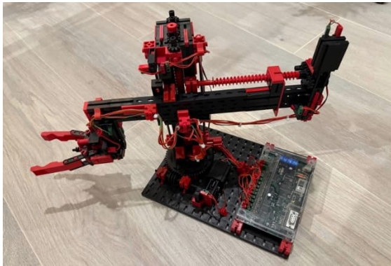
Abb. 9: Industry-Robots-II-Modell mit simulierten Encodermotoren
