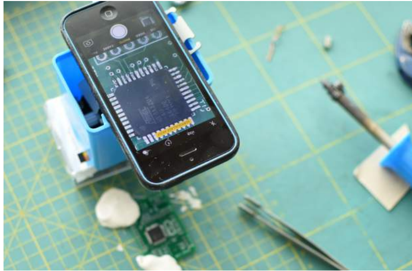
FIGURE 18 – Soudage du microcontrôleur sur le PCB
