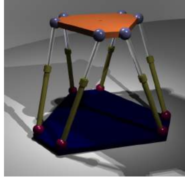
(b) Plateforme de Stewart à actionneurs linéaires
