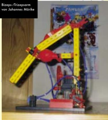
Dass man mit fischertechnik auch gute Noten erzielen kann, hat uns Johannes Mörike aus Pliezhausen berichtet. Für den Biologieunterricht konstruierte er einen pneumatischen Bizeps-/Triepsarm aus fischertechnik, der anschaulich die Funktion des menschlichen Armes simuliert. Echte Bionic.
