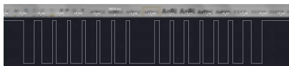
Abb. 3: Signal am Empfänger SFH5110 dargestellt im Logik-Analysator: nach dem achten Puls wurde eine Pause verschluckt.
